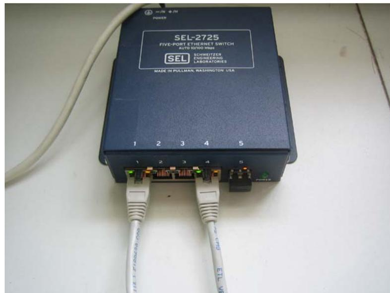
Switch Adaptador señal Internet SEL- 2725, con un cable de entrada desde Router D-LINK(superior) , y dos cables de salida : uno hacia Equipo SEL2411, y el otro hacia Notebook IBM.
