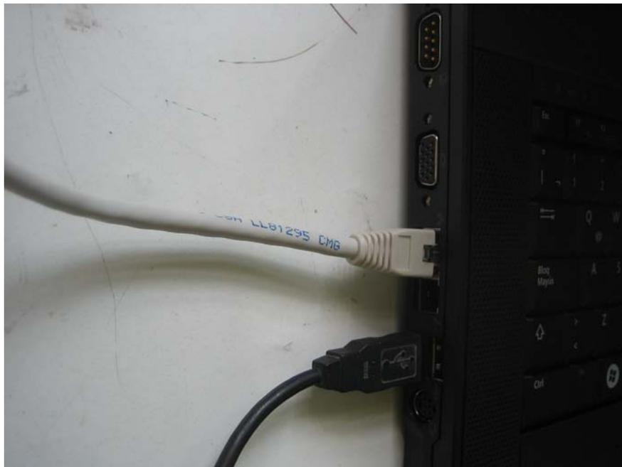
El Notebook conectado al Equipo UTR ( Unidad Terminal Remota) mediante una puerta USB ( cable negro), y también conectado a Internet mediante Ethernet (cable blanco) (puerto RJ-45).
